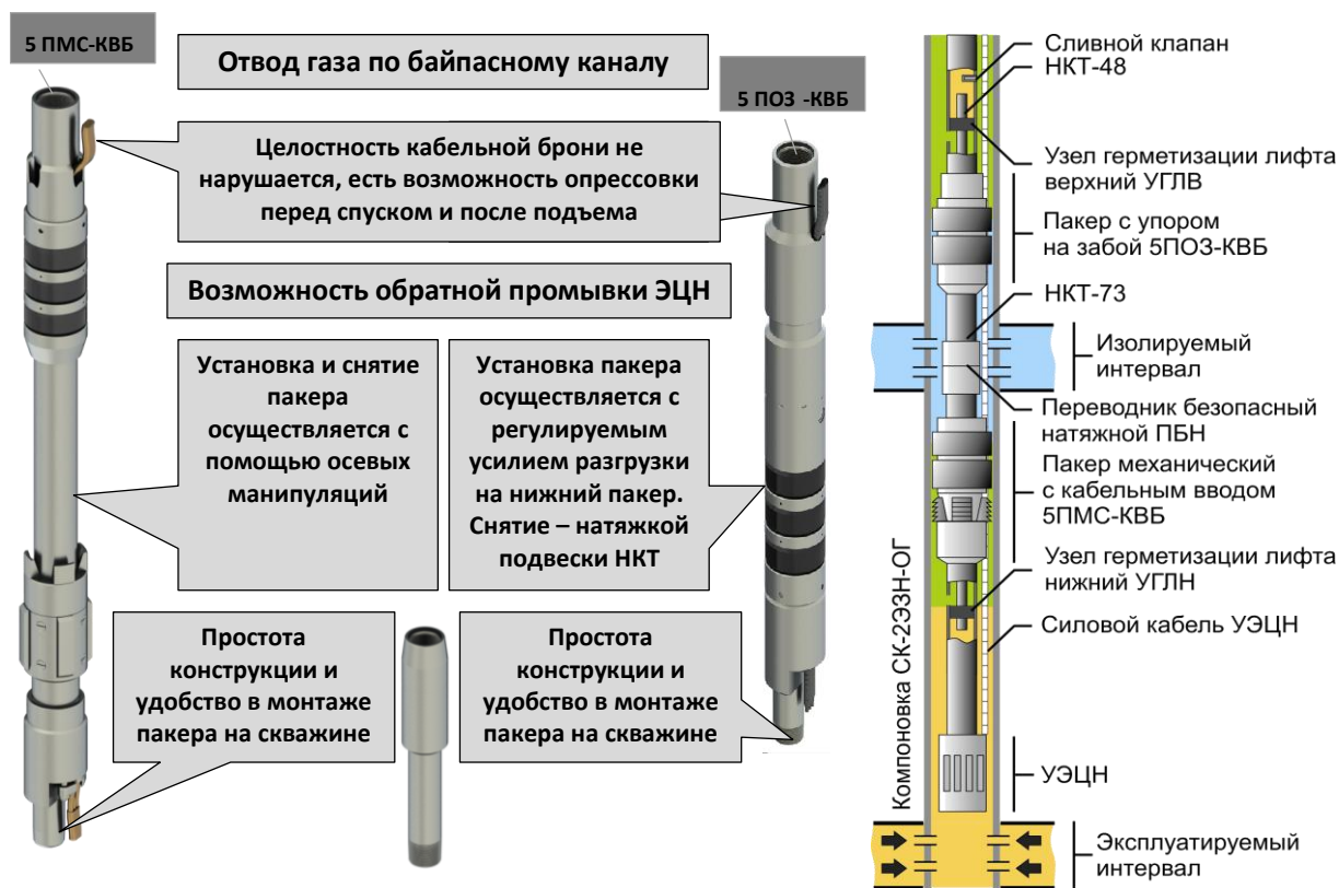
Рис. 8. Схема двухпакерной компоновки с кабельным вводом и с отводом газа
